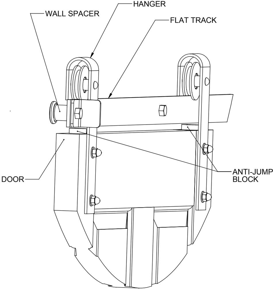
THE ANTI JUMP BLOCKS CAN BE PIVOTED OUT OF THE WAY SO THE DOOR CAN BE HUNG ON THE TRACK. ONCE THE DOOR IS HUNG, PIVOT THE BLOCKS BACK TO PREVENT THE DOOR FROM COMING OFF THE TRACK.
